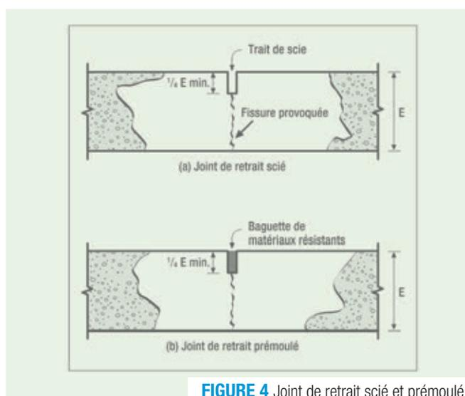
FIGURE 4 Joint de retrait scié et prémoulé
