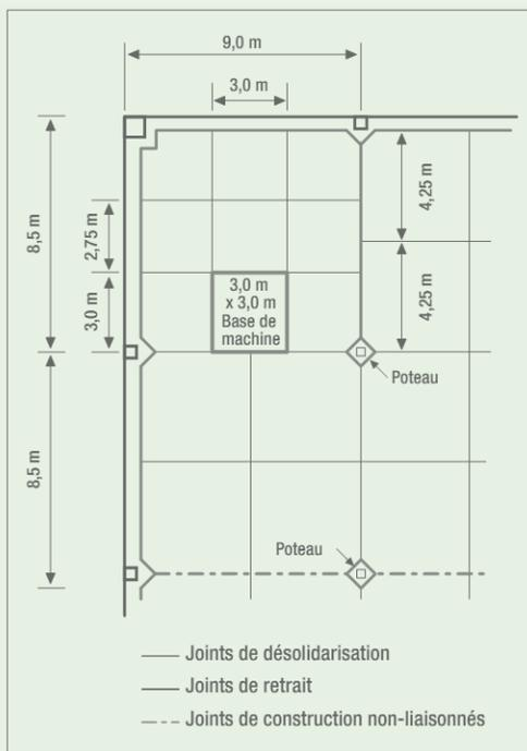
FIGURE 2 Disposition caractéristique des joints dans une dalle<sup>3</sup>
